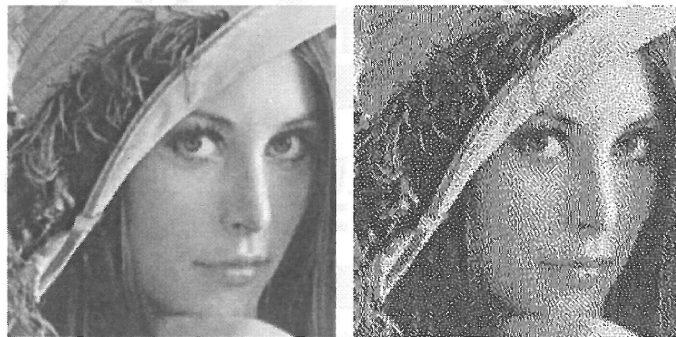
圖 2-5 左：Lena 灰階影像，右：Lena 使用錯誤擴散法產生之半色調影像
