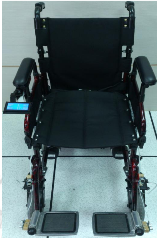
圖 2.71 電動輪椅 LCD 以及超音波模組安裝圖
