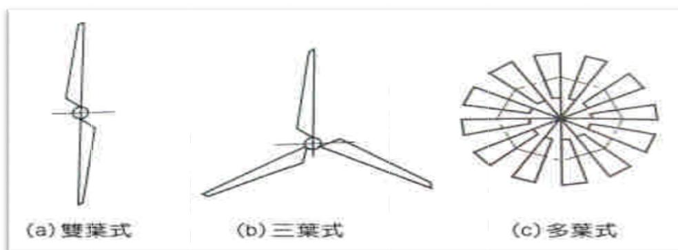
圖 3 水平軸式翼式風力機
