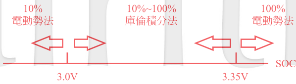
圖 10 三階段 SOC 估測法的架構圖
